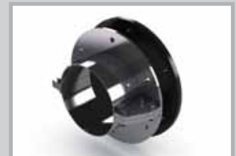
Vorbaufansch geteilt Zur nachträglichen Abdichtung vor einer Kernbohrung in einer Wand oder Decke. Wird mit EPDM-Flanschdichtung und Befestigungselementen geliefert. Ausführung in Edelstahl.
